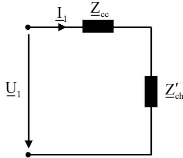
Ainsi, afin de pouvoir calculer la puissance apparente et le courant au primaire, les différents paramètres du schéma doivent être établis.
